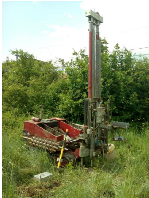
Figura 6: Penetrometro PAGANI in assetto statico per la realizzazione delle Prove con Cono sismico
